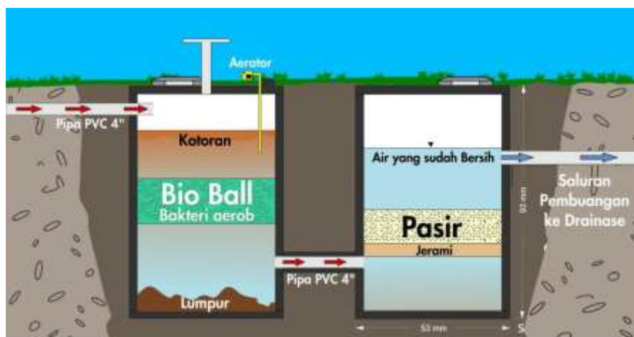
Gambar 3. Ilustrasi tangki bio-porta di dalam tanah.
