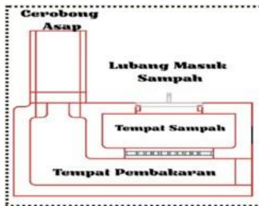
Gambar 4. Ilustrasi bagian dalam Rocket Stove
