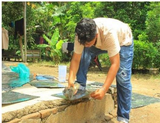
**Gambar 3.** Proses pemotongan seng untuk pembuatan Plang
