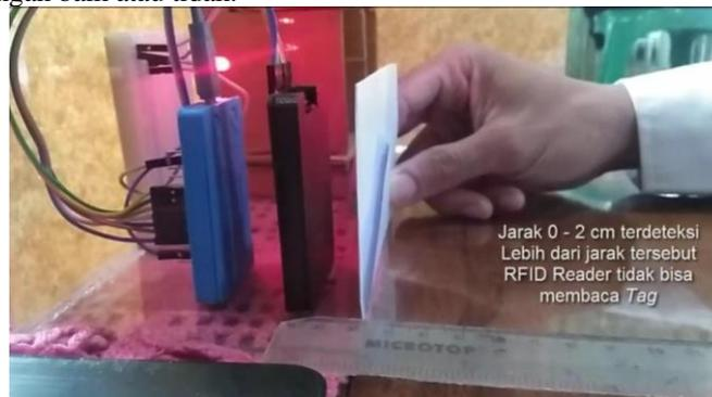
Gambar 7. Pengujian jarak MFRC-522
