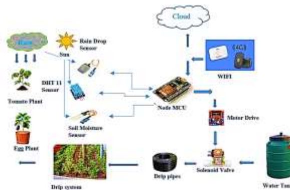
Gambar 1. Diagram blok arsitektur sistem Smart Garden berbasis IoT dengan sensor soil moisture, NodeMCU ESP8266, dan koneksi cloud untuk monitoring otomatis.
