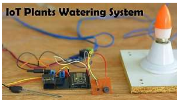
Gambar 2. Prototype IoT Smart Garden berbasis NodeMCU ESP8266 dengan sensor soil moisture dan kontrol pompa air untuk penyiraman otomatis.
