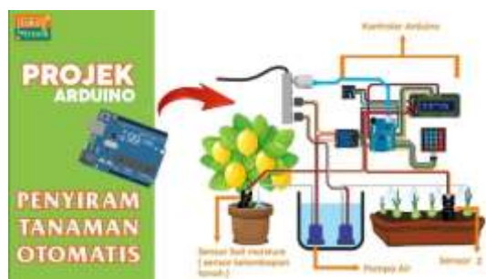
Gambar 3. Prototipe sistem penyiraman otomatis tanaman dalam pot menggunakan sensor soil moisture dan pompa air dengan mikrokontroler Arduino/NodeMCU.
